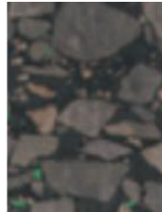
Məsəmələri mineral toz bitum qarışığı ilə dolmuş təbəqə (dəlik mikroskopiyası)
