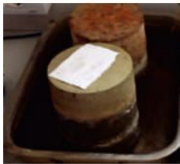
6 ay ərzində su hovuzunda saxlanılan DOROSOL®C30 -la emal edilmiş gilli qruntlar nümunəsi
