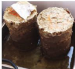
3 ay ərzində su hovuzunda saxlanılan emal edilməmiş gilli qruntlar nümunəsi
