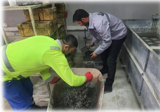
Aerodrom uçuş eniş zolağının beton tərkibinin tutulması
