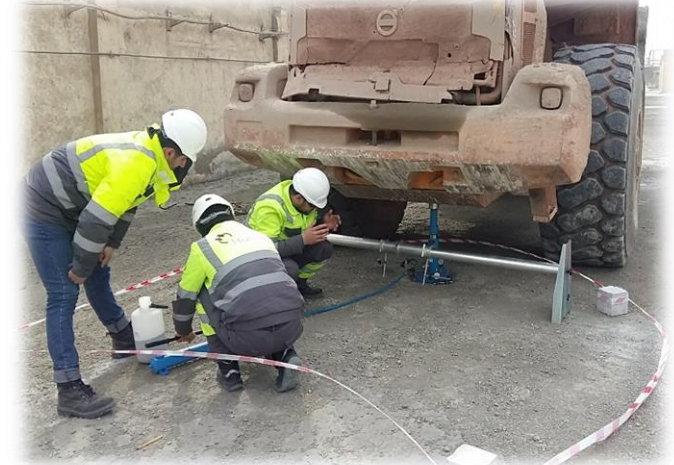
Holcim ASC-nin zəmin sınaqları
